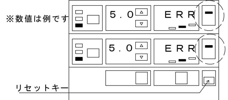
表示が点灯点滅して停止出力を出します。
